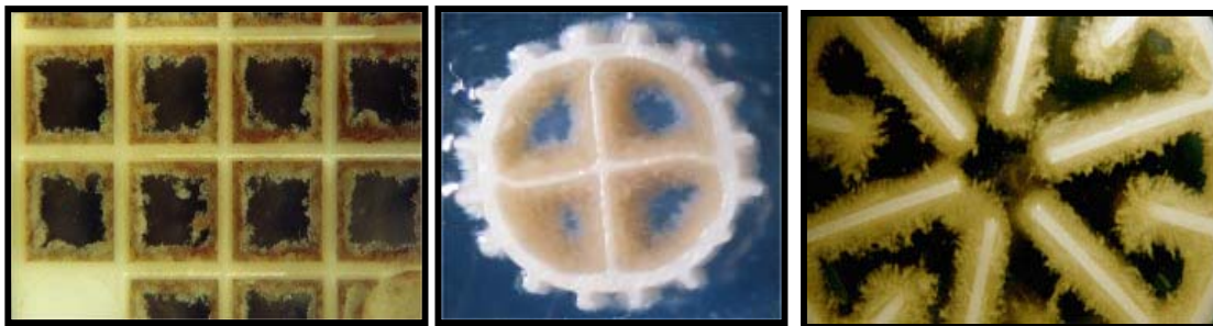
Rys. 6. Rodzaje biofilmu na kratkach przepływowych w instalacji wodno-kanalizacyjnej.
